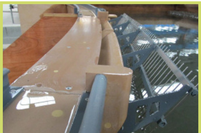
Modèle réduit du barrage des Cammazes créé pour tester l'efficacité des aménagements projetés.
